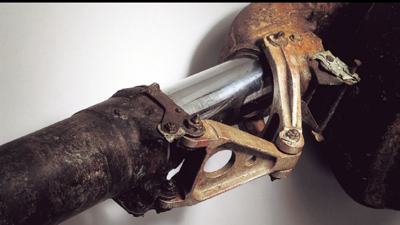
1977年に瀬戸内海の海底から発見された零戦の主脚「オレオ」は、30年以上海中にありながら、摺動部のめっきは光沢を保ち、当時の技術の高さを証明しています。
