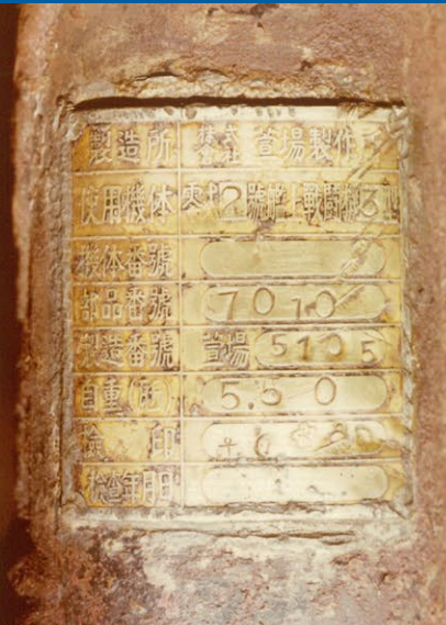
1977年に瀬戸内海の海底から発見された零戦の主脚「オレオ」は、30年以上海中にありながら、摺動部のめっきは光沢を保ち、当時の技術の高さを証明しています。
