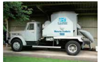
のちに国立科学博物館から未来技術遺産に指定されたハイロー型ミキサ車
