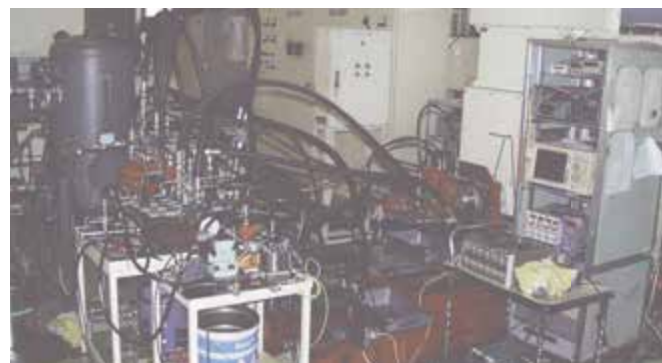
KYB 相模工場 ポンプ・バルブ システム試験設備
