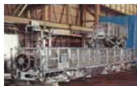
瀬戸大橋点検補修作業車 (内面作業車)
