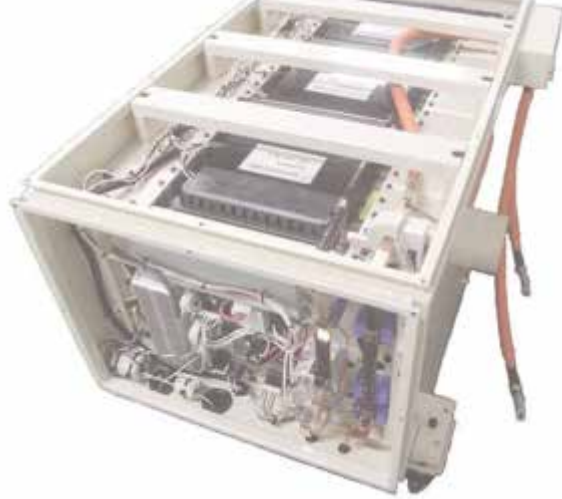
EHESS バッテリーシステム
