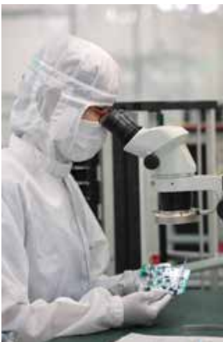
基板の目視検査
