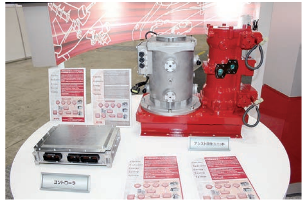
写真12 ハイブリッドシステム向けアシストシステム
