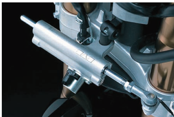
写真4 レシプロ式電子制御ステアリングダンパ 5)
