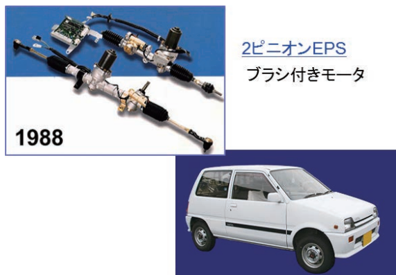
ダイハツミラ(660cc) 写真1 軽自動車向けEPS
