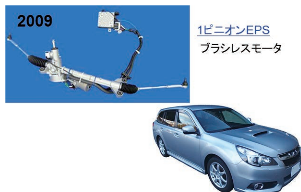
スバルレガシィ(2500~3000cc) 写真4 ブラシレスEPS
