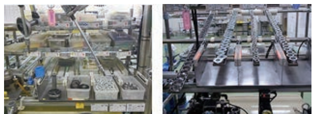
写真2 箱供給（左）から実のみ供給化（右）
