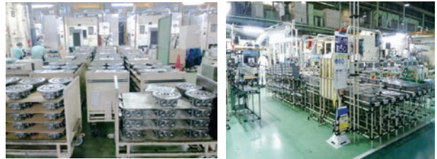
写真1 台車置き（左）からレーン化改善（右）
