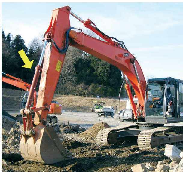
図9 ロッド内配管シリンダ搭載の様子(中型機)
