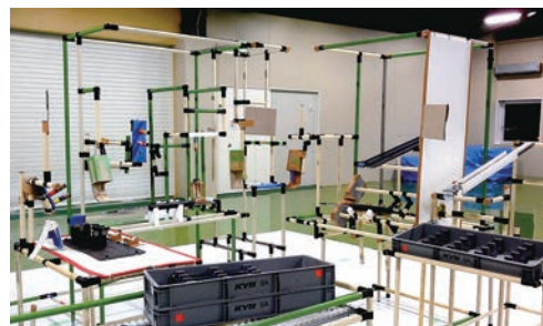
写真1 模擬設備による作業シミュレーション
