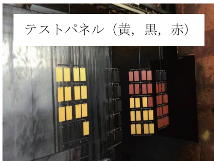
写真4 KYBIでの塗装試験
