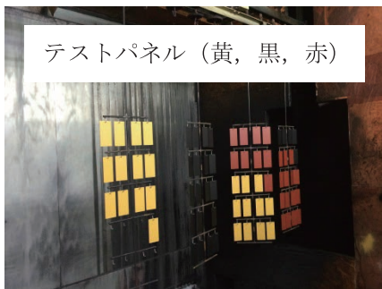
写真4 KYBIでの塗装試験
