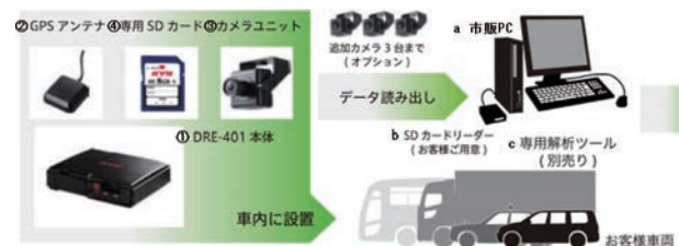
図1 ドライブレコーダの構成図
