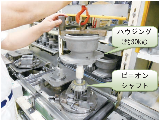
写真7 クレーン作業
