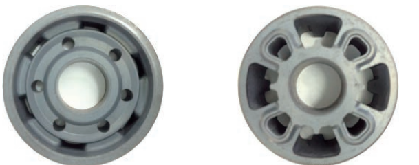
(a)従来バルブ [環状シート面] (b)減衰力応答性改良バルブ [独立シート面]
