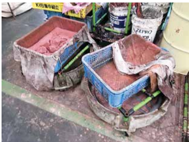
写真8 廃棄品ばかりで自作したろ過装置
