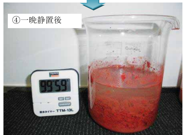
写真6 酸によって自ら固まっていく様子
