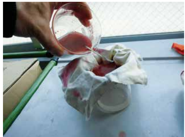
写真7 ウエスで濾過する試験
