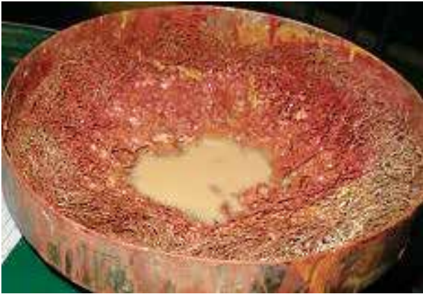
写真5 固まる時が予測不能な塗料廃液
