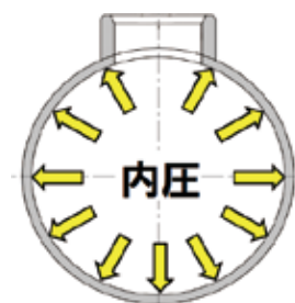
図18 中間パイプに加わる圧力
