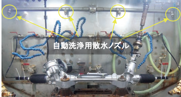
写真2 泥塩水耐久試験機内部
