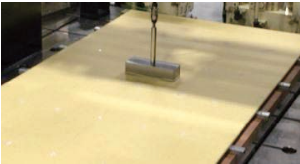
写真5 天井静的破壊荷重測定
