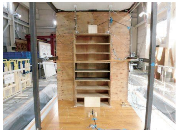
写真2 3軸振動台実験状態
