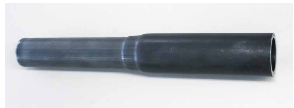
写真3 塑性加工したステアリングシャフト素材
