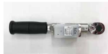
写真6 データ転送式レンチ
