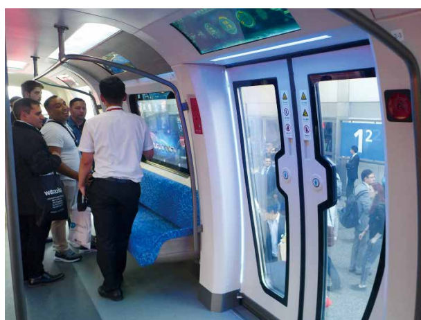
写真6 CFRP適用車両内部
