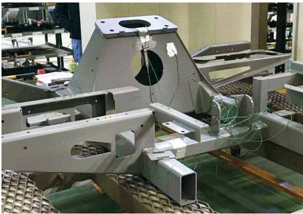
写真6 物温 (フロントフレーム) 測定実施例
