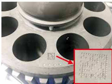
写真3 2次元コードをマーキングした加工部品
