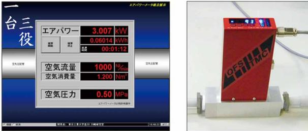
1. エアパワー 2. 流量 3. 圧力を同時に計測することが可能.
