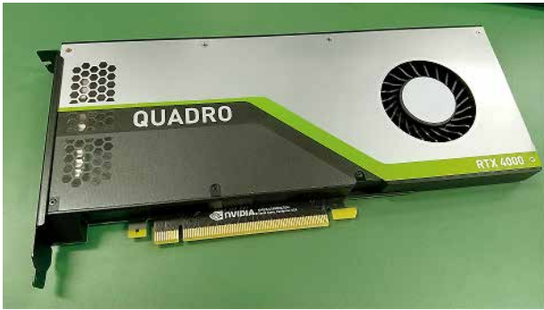
写真6 GPUグラフィックボード (例：NVIDIA QUADRO RTX4000)
