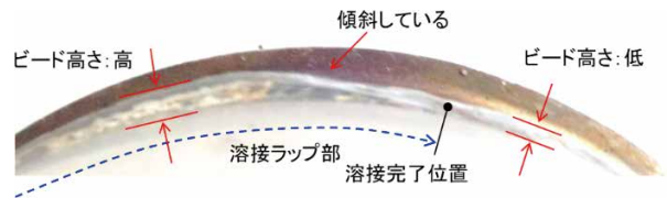
写真4 溶接完了位置付近のビード形状
