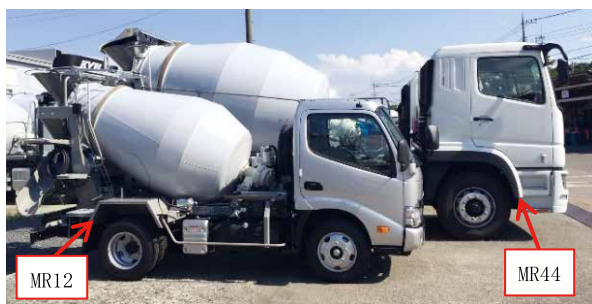
写真1 大型ミキサ（MR44）と小型ミキサ（MR12）
