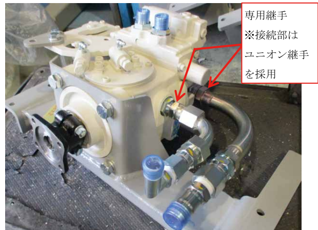
写真8 ポンプの専用継手
