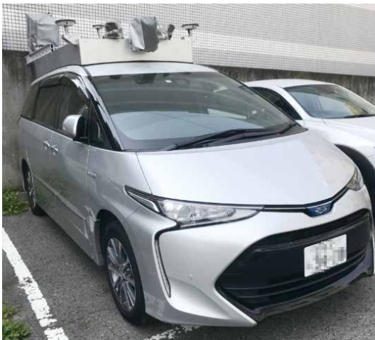
写真6 MMS搭載車両 (株式会社三英技研HPより転載)
