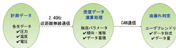
図6 計測データ変換処理
