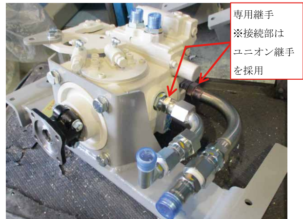
写真8 ポンプの専用継手
