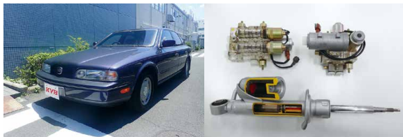
写真1 (左) INFINITI Q45 (右) KYB製油圧アクティブサスペンション
