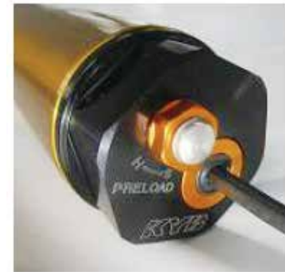
写真5 スプリングイニシャル調整アジャスタ外観
