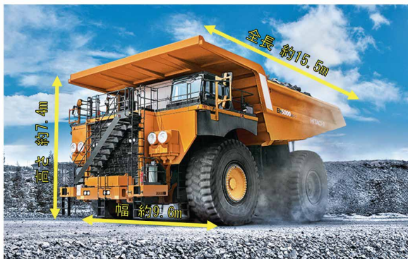
写真2 日立建機様 EH5000AC-3 外観 （日立建機様ホームページ写真に車体サイズを追記）
