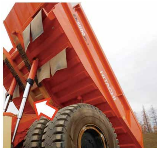
写真6 ホイストシリンダ搭載位置
