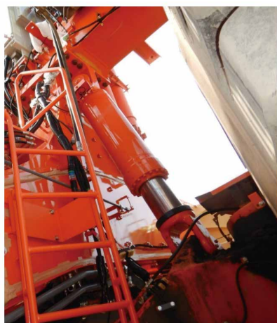
写真4 ①フロントサスペンションシリンダ 取り付け状態
