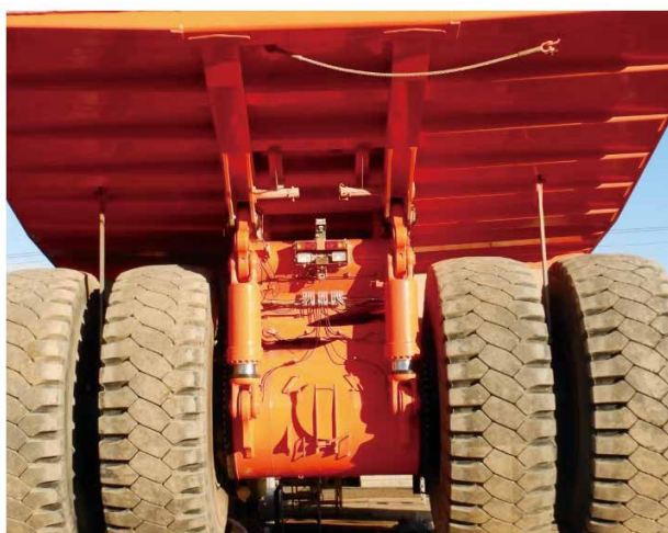
写真5 ②リアサスペンションシリンダ 取り付け状態
