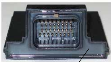
写真2 ポッティング材による充填
