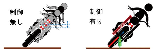
図3 コーナリング中の重心の変化
