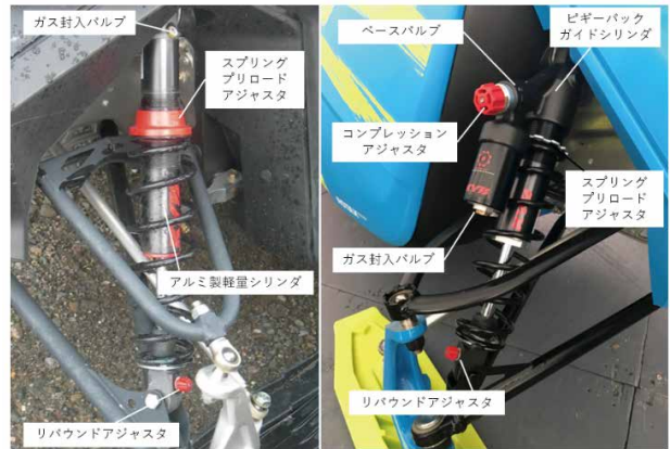
図3 軽量アルミシリンダ単筒式ガスSA(左)とピギーバック式ガスSA(右)
