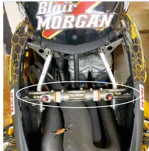
図9 ホース別タンク式ガスSAフロントショック (コンプレッションアジャスタ付き)
