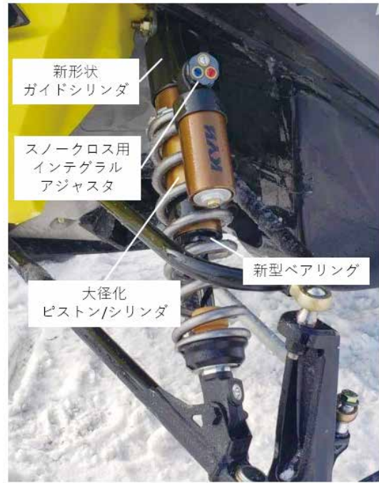
図11 2018-2019シーズンに投入された新型大径ピストンフロントショック
