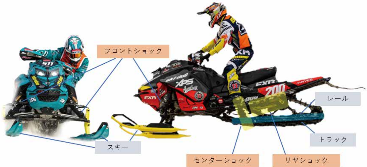
図2 スノーモービルのサスペンション関連部品名称
