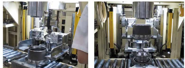
写真2 重量部品組立の自動化
