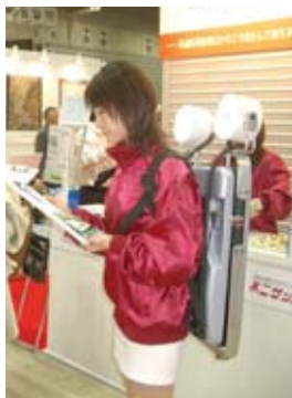
背負子式ソーラ投光器 (重量を約9kgまで軽量・小型化)
