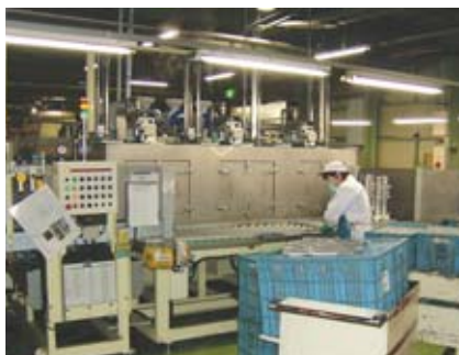
水系洗浄機の導入(岐阜南工場)
