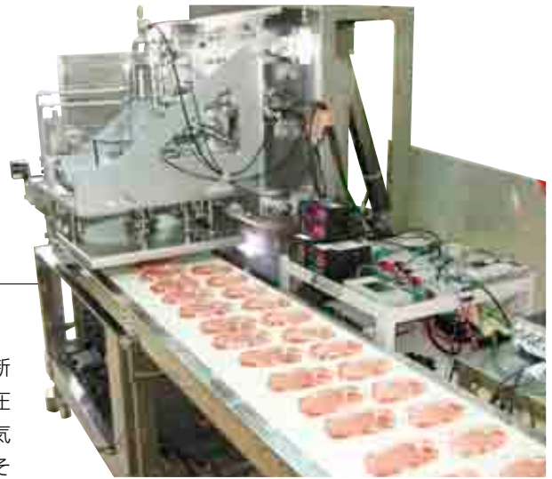
●水圧駆動式食肉スライサー 独立行政法人農畜産業振興機構助成事業に基づき、財団法人日本食肉生産技術開発センター研究開発事業にてワタナベフーマック株式会社と共同でモニタ機の開発をしました。
