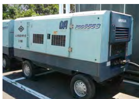
設置したエンジンコンプレッサ
