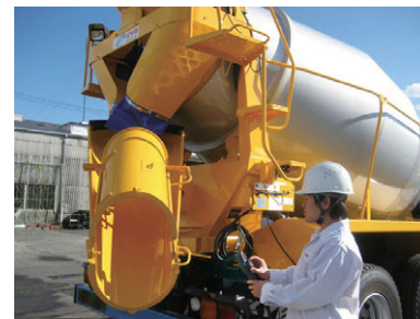
排出口付近でのリモコン操作の様子
