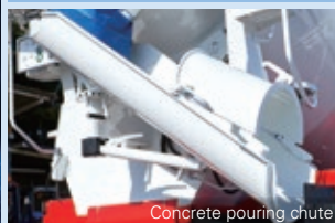
Concrete pouring chute
