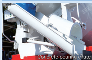
Concrete pouring chute
