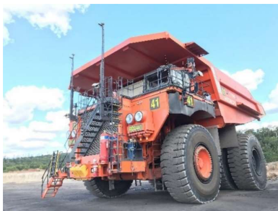
用于自动驾驶系统的自卸卡车（日立建机株式会社提供）
