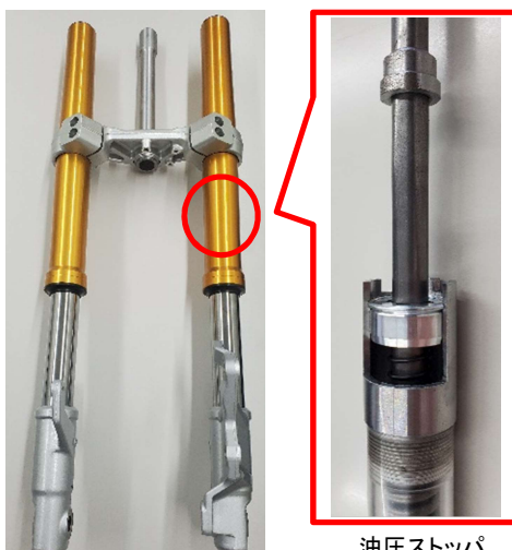
KMSI (KYB Motorcycle Suspension India) 製 小径倒立型フロントフォーク
