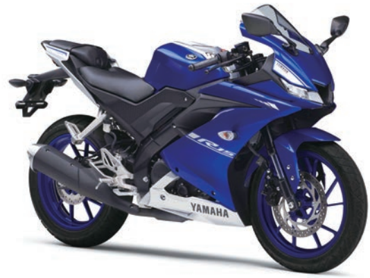
写真4 φ37倒立FF採用車種 YZF-R15 注5) (ヤマハ発動機株式会社ホームページより)
