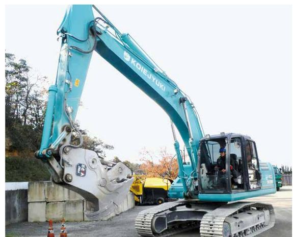
図8 KCH-UD搭載 建築廃材リサイクル機
