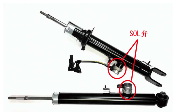
写真1 外付け式SOL減調SA外観
