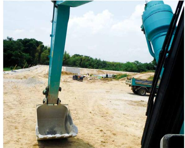
図4 油圧ショベルのオペレータ視界
