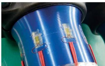
写真5 応力測定用のゲージ（例）
