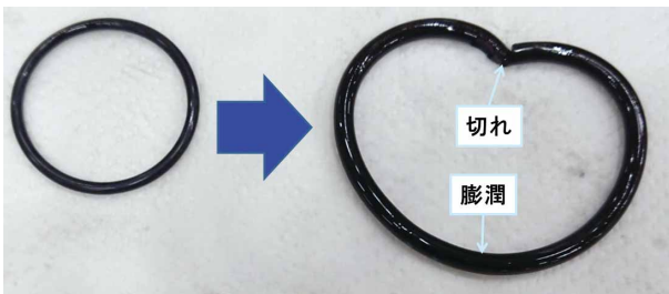
写真2 作動油の攻撃性(パッキンの例)
