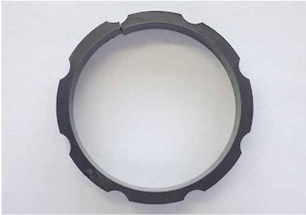
写真1 油通路付ピストン軸受
