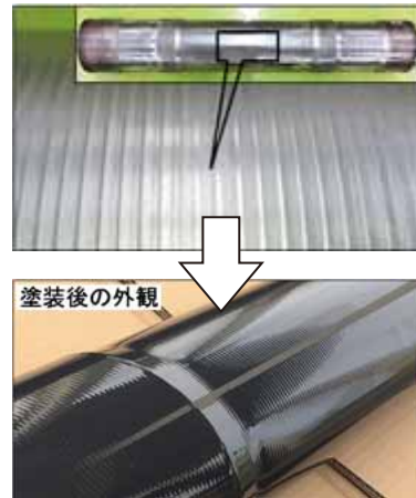
写真1 改善前のローラフィードマーク
