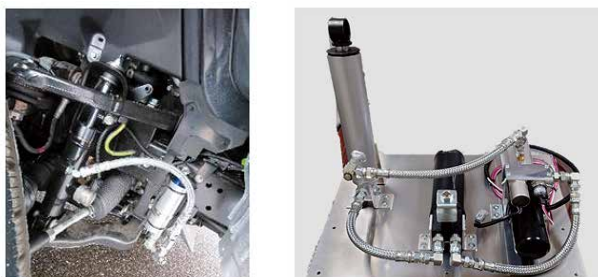
写真7 前輪：減調SA・後輪：車高調SA
