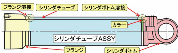
図4 現状のシリンダチューブアッセンブリモデル
