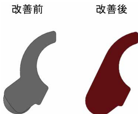
図15 吸い込み油路の拡大
