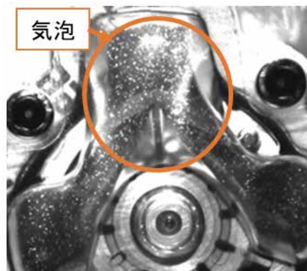
図2 作動油中の気泡
