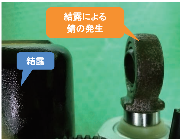
写真11 ワークの結露・錆の発生
