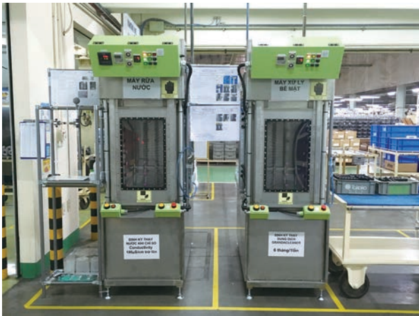
写真13 前処理洗浄機 (右:前処理, 左:水洗)
