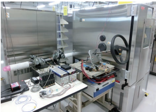
写真7 ECU低温時動作確認試験
