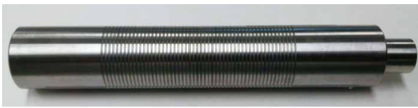
写真1 めっき前ピストンロッドの試作品外観
