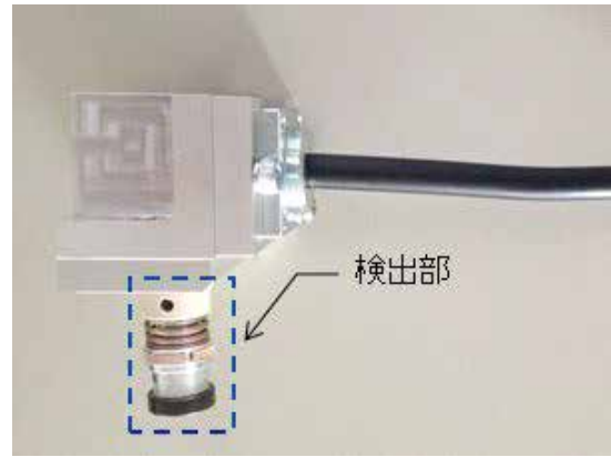
写真2 磁気センサ（試作品）外観
